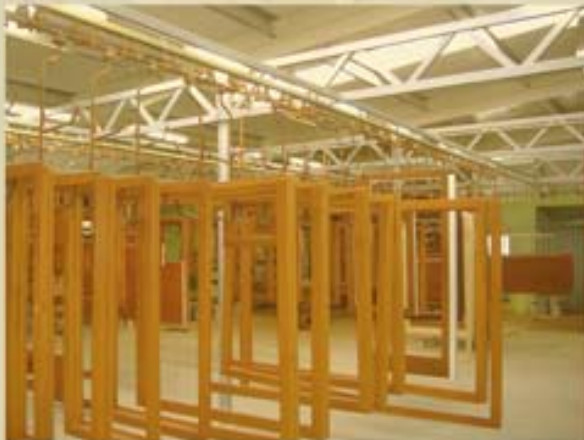
Linka povrchové úpravy oken - cz
